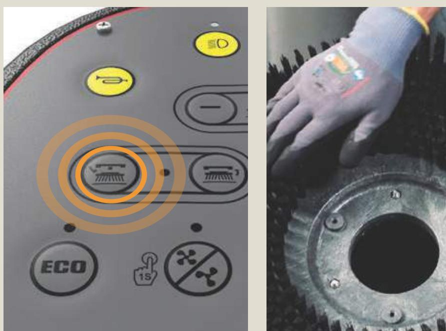
Когда ключ находится в положении «Вкл.», нажать кнопку снятия щётки, чтобы снять щётку/пэд для осмотра и очистки.
