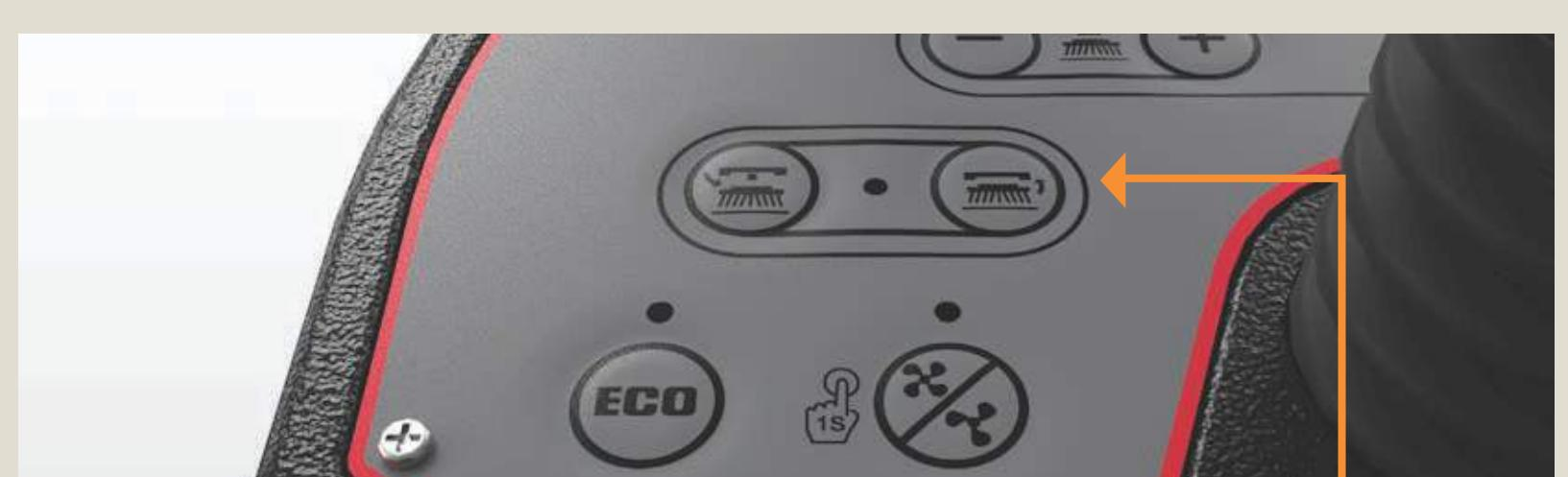
Повернуть главный ключ в положение «Вкл.» и нажать кнопку фиксации щётки. Дека опустится, медленно повернется щётки до их фиксации.
