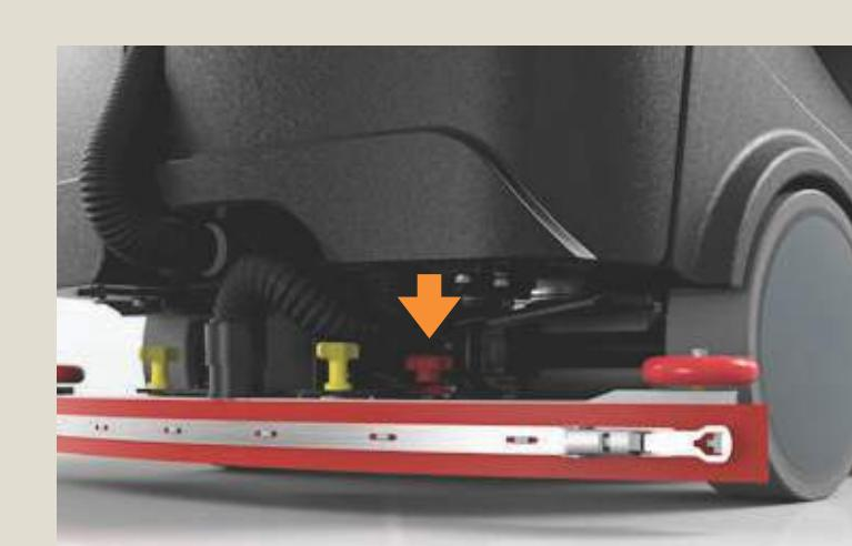
С помощью регулировочных винтов выставить угол скребка и давление лезвия, чтобы обеспечить эффективный сбор воды.
