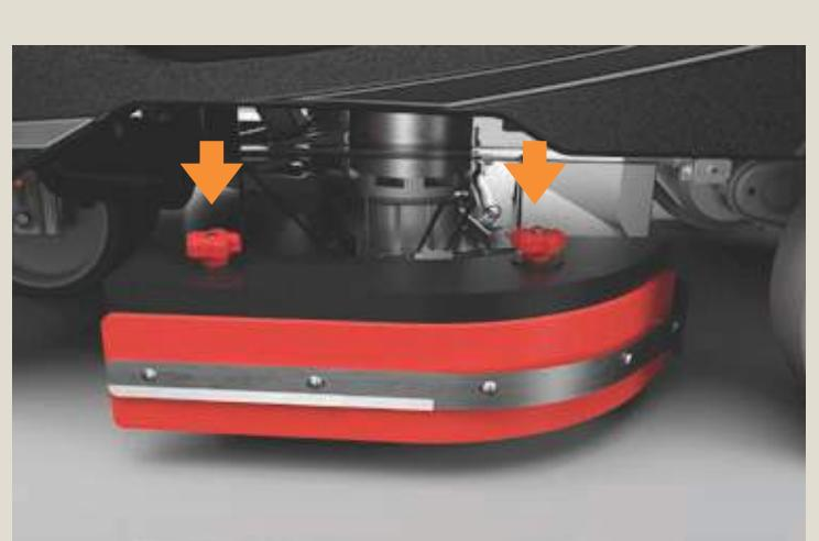
Освободить две ручки, чтобы снять боковую юбку.
