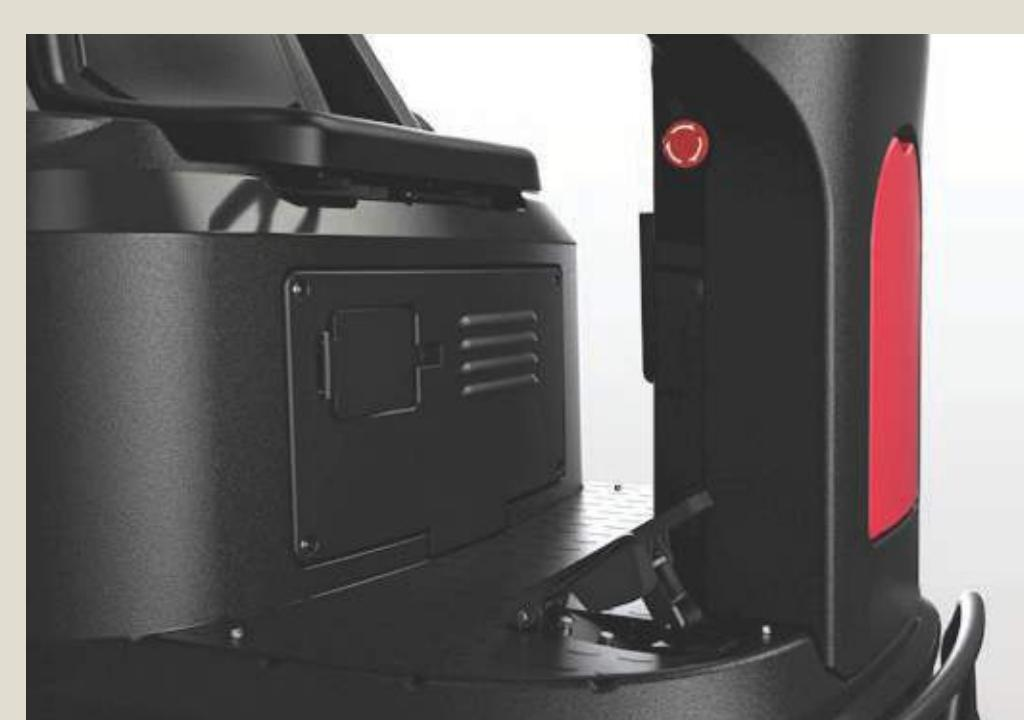
Подключить зарядное устройство к гнезду на машине, затем включить его в розетку.
