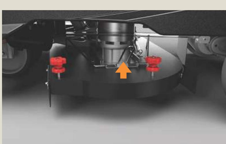
Щетка устанавливать вручную, либо автоматически. Для автоматической установки требуется надавить на металлическую ручку и разместить щетку под декой в соответствующее положение до упора о стержни, затем отпустить ручку. Установить на прежнее место боковую юбку.
